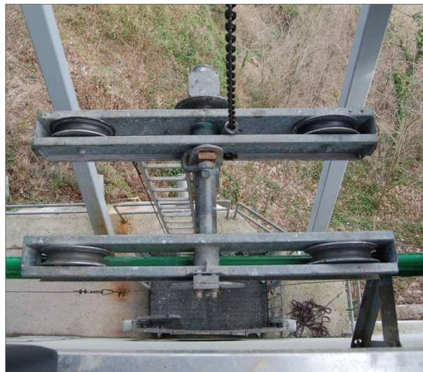
*foto 6,7: a sinistra la vettura di soccorso, a destra particolare del carrello con bilancieri a due rulli*
