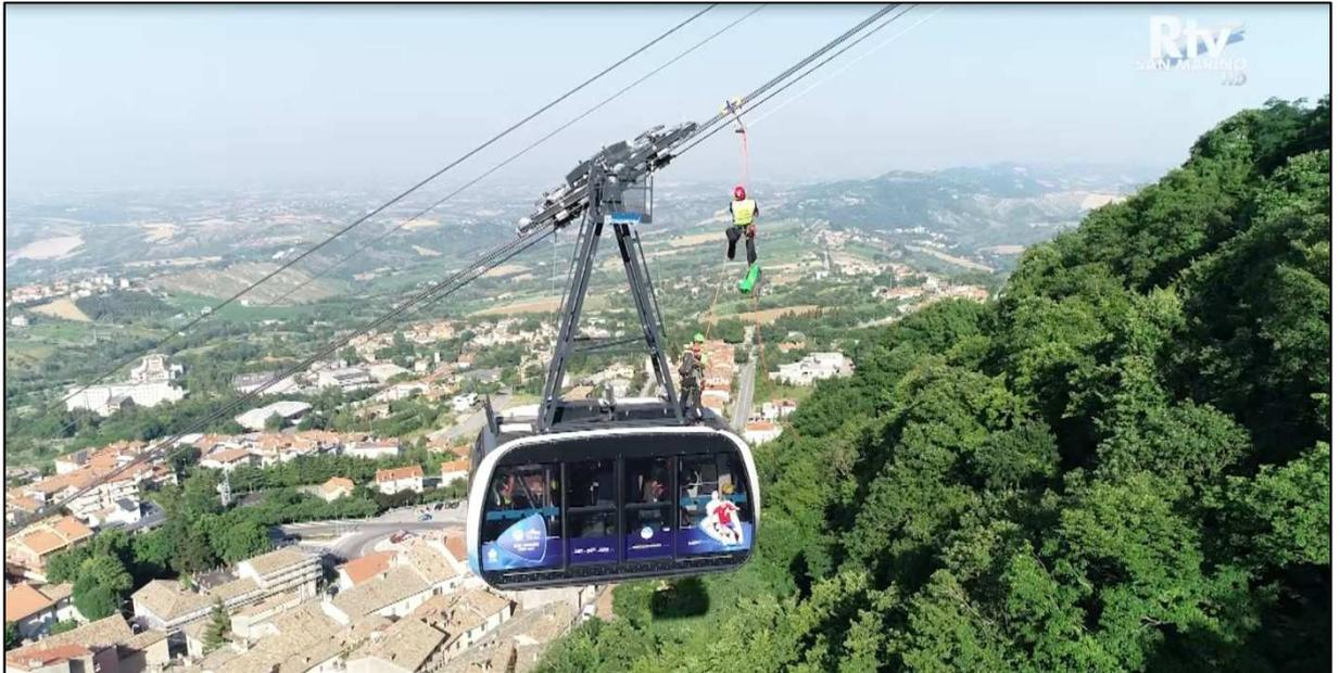
*foto 17: arrivo operatori SAER in cabina tramite carrellino su fune.*
