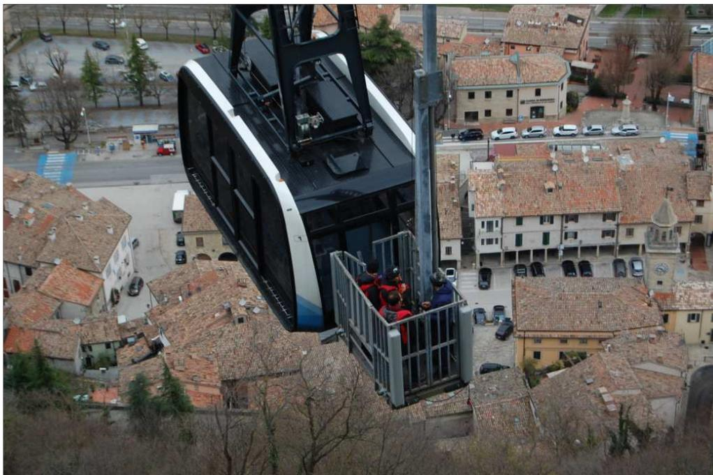
*foto 12: particolare del trasbordo con la vettura di soccorso*
